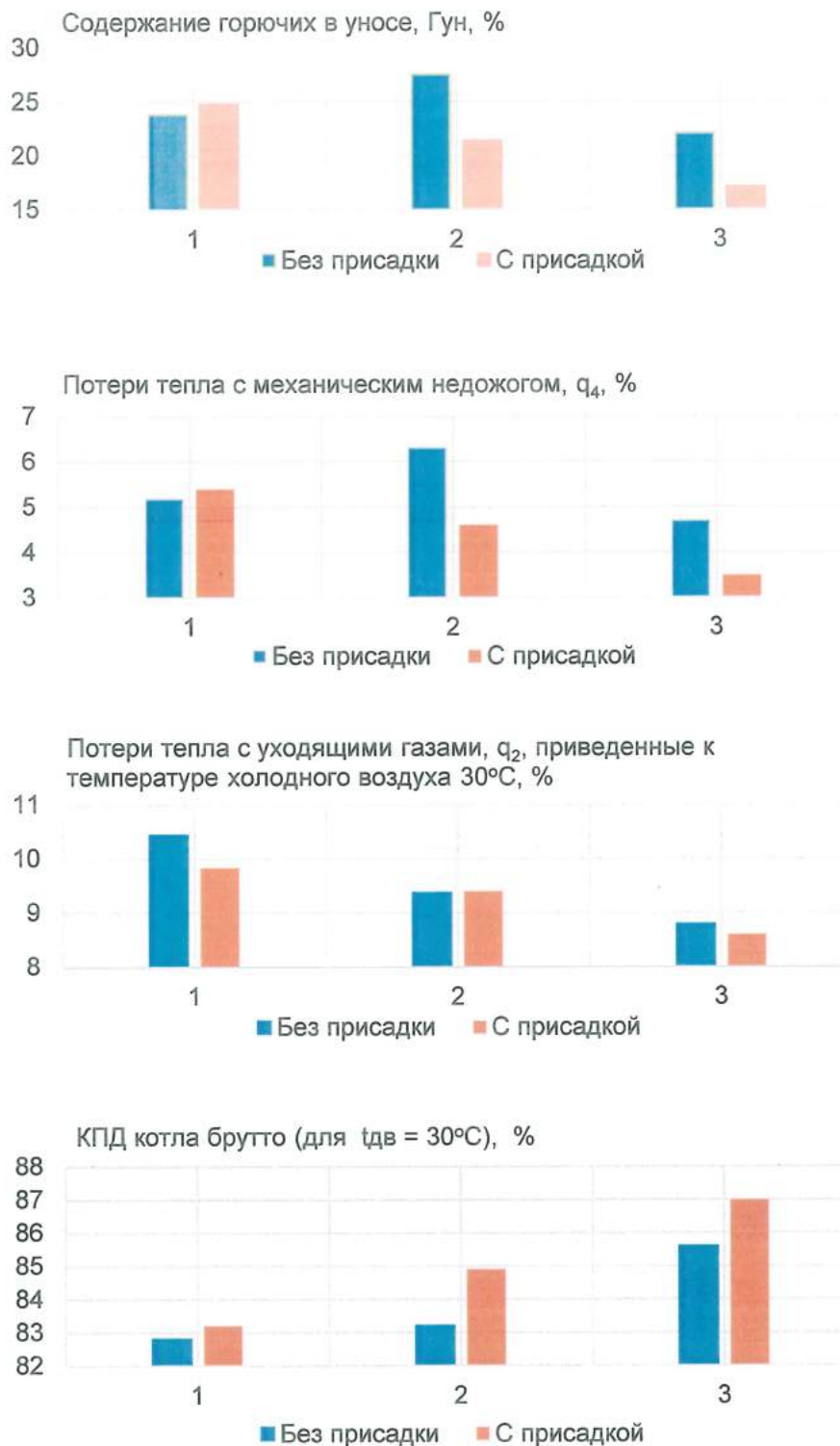
Рис. 4.3. Содержание горючих в золе уносе, потери тепла, КПД котла брутто при сжигании угля в котле К-50-14-250 №4 без присадки и сприсядкой
